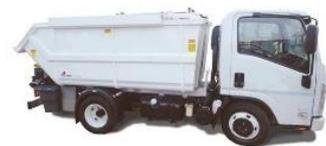
Mini compattatore con vasca da 5 mc con voltabidone e voltacassonetti, impiegati nella viabilità ordinaria
