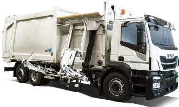
Compattatore da 23/26 mc su telaio tre assi carico laterale impiegati nella viabilità ordinaria
