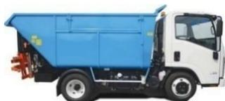
autocarri con vasca semplice di capacità di 5 metri cubi con voltabidone e voltacassonetti, impiegati nella viabilità ordinaria
