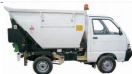
autocarri tipo Porter o similare, con vasca di capacità 2,5-3 metri cubi impiegati prevalentemente nei centri storici e nelle strade a viabilità ridotta
